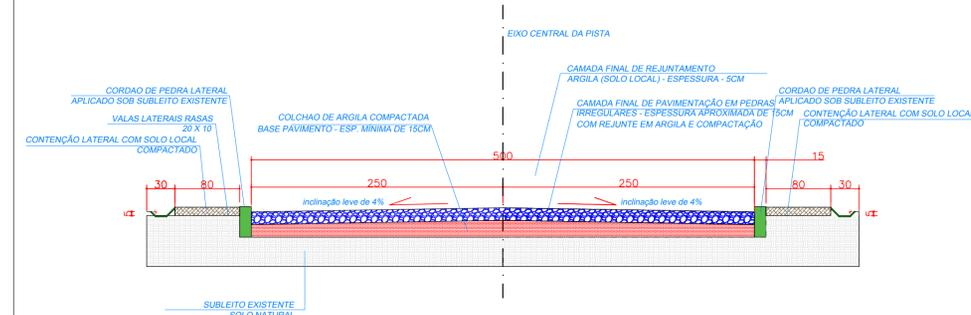
DETALHE CONSTRUTIVO - SEÇÃO ESQUEMÁTICA SEM ESCALA
