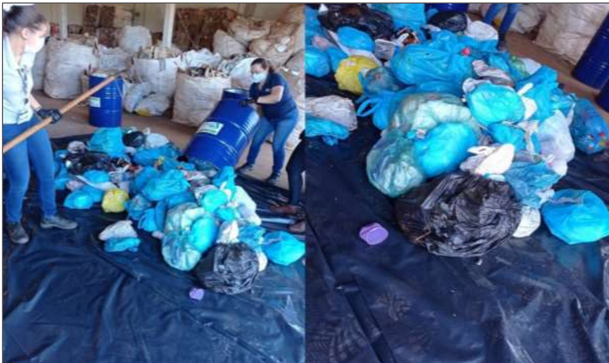
Figura 48. Disposição na lona dos resíduos das bombonas para o estudo da composição gravimétrica dos resíduos do município de Catanduvas/PR
