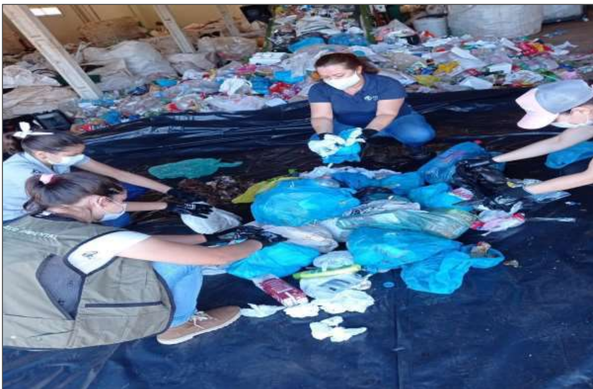
Figura 50. Separação para posterior pesagem em balança digital e classificação dos resíduos segundo sua tipologia para o estudo da composição gravimétrica dos resíduos do município de Catanduvas/PR
